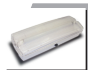
Model : PEL 211 NM/WP (1) Lamp Type : 2 x 11W CFL Accumulator : Ni-Cd Battery Backup : 2 Hrs. Standard Pkg.: 10 pcs. Box size mm : 490x305x400
